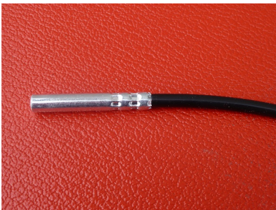
Fig. 1: Sertissage mécanique d'un détonateur N° 8
